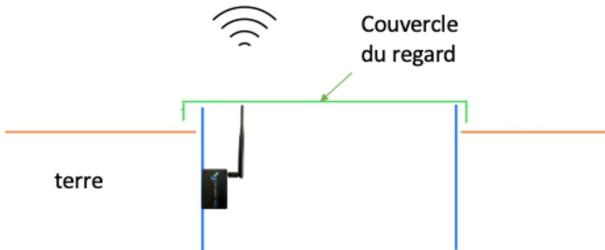
Si vous avez une antenne déportée avec un câble de 1 mètre pour pouvoir poser le Tag Tensiométrique au fond du regard et de fixer l'antenne sur le dessus du couvercle du regard en le perçant.
